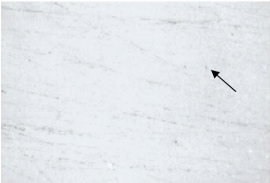
图 2 自凝塑料试件放大照片 自凝塑料的表面质地均匀, 箭头处黑点为小气泡
