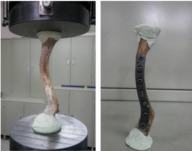
a:空心钉轴向挤压实验;b:钢板轴向挤压实验
