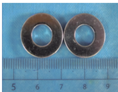
图 2 实验用环形磁铁
