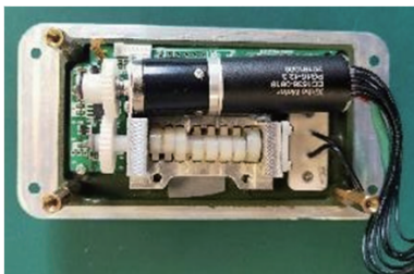
图3 半挤压式输液泵泵体结构图
